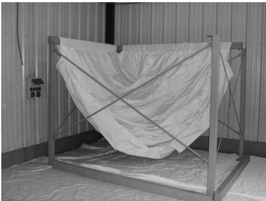
Abb.: Einhängen des Silosacks
